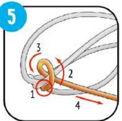
Возьми проволоку и закрепи её на левой нижней части каркаса. Далее оберни эту проволоку вокруг верхней проволоки, как показано на рисунке.
