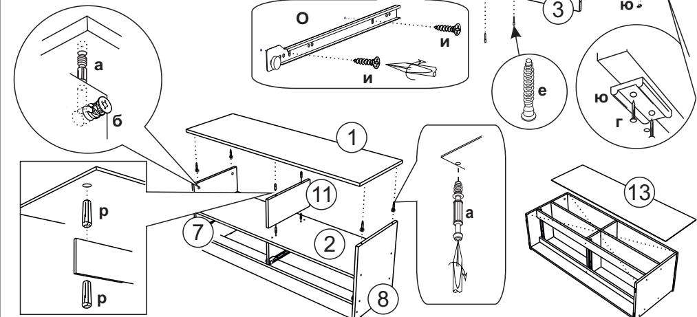
4. На крышку (1) устанавливаем шток эксцентриковой стяжки (а). Шкант вставляем в готовые отверстия на крышке и вязке (2). После чего крышку соединяем со средней боковиной (11) шкантами (р), а боковины (7,8) эксцентриковой стяжкой (б).
