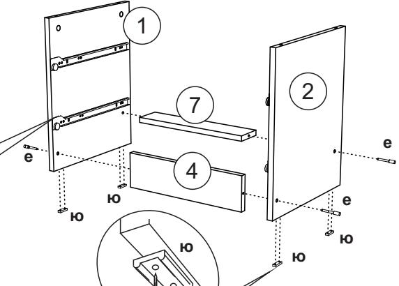
4. Подготовленные боковины (1,2) соединяем между собой цоколем (4) и планкой (7) при помощи еврошурупов (е).
