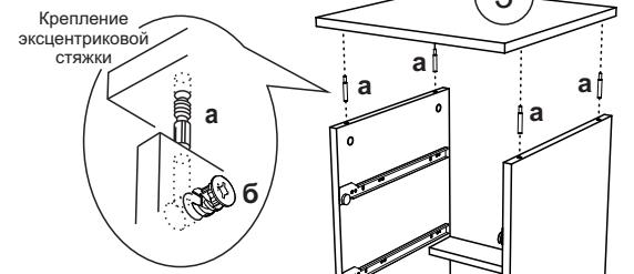
5. К собранному узлу крепим крышку (3), предварительно ввернув в неё штоки эксцентриковой стяжки (а) и стягиваем чашкой эксцентриковой стяжки (б).
