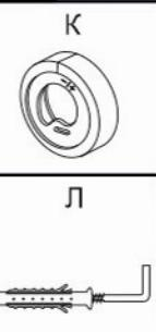
! Установите крепежный элемент (Л) к стене согласно размерам, указанным на рисунке.
