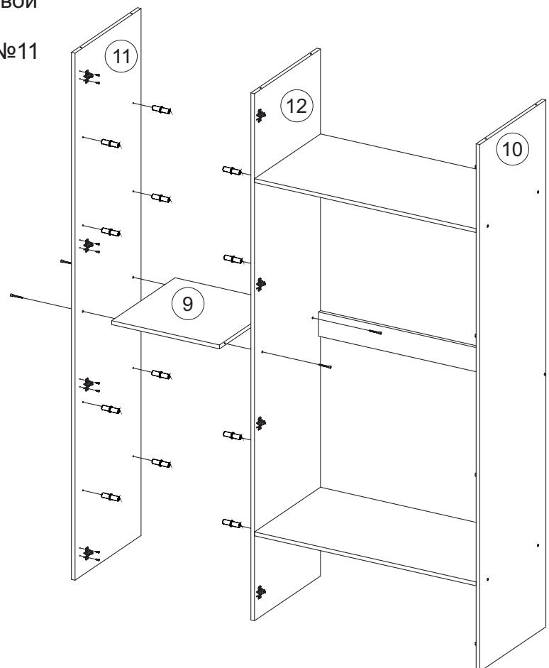
**4.** С помощью евровинтов соедините крышки №8 с боковинами №10, №11 и перегородкой №12.
