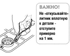
**1** Прежде, чем отрезать деталь от литниковой рамки, сверьте её номер с инструкцией.
