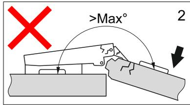
Петли фасада открываются на фиксированный угол (см. схему 1). Открывание фасада на больший угол (см. схему 2) может привести к повреждению деталей и поломке петель.
