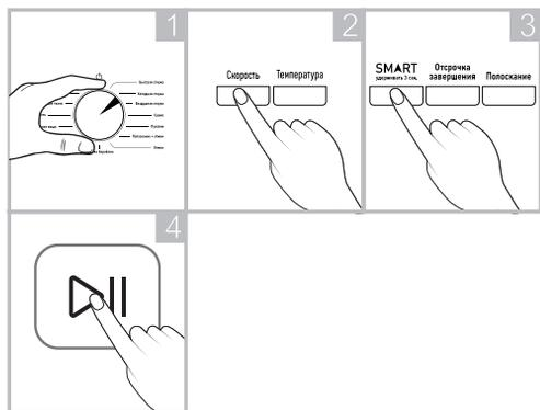
1. При помощи поворотного переключателя выберите желаемую программу стирки.
