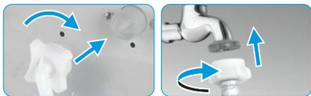
1. Проверьте наличие резиновых прокладок на обеих сторонах заливного шланга. При необходимости вставьте резиновые прокладки в резьбовые фитинги каждого шланга для обеспечения герметичности.
