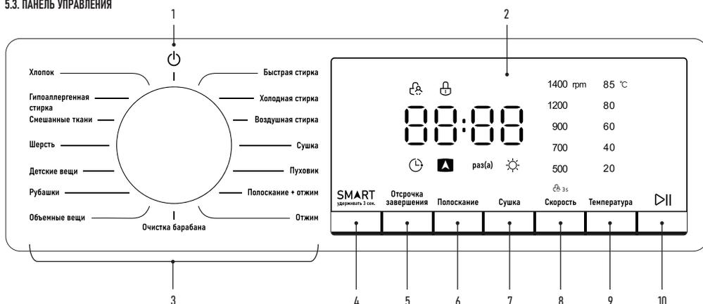
1. Положение поворотного переключателя для выключения машины
