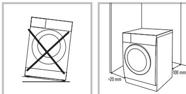
1. Поверхность, на которую стиральная машина будет установлена, должна быть сухой, ровной и твердой.
