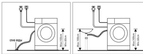
**ПРИМЕЧАНИЕ:** если конец сливного шланга выведен в раковину, как и в случае с выводом в ванную, используйте специальный держатель (кронштейн, скобу), а также надежно закрепите держатель с помощью цепочки или веревки.
