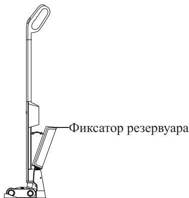
6. Закройте заглушку и установите резервуар для чистой воды в корпус электрошвабры до щелчка. Резервуар должен плотно прилегать к корпусу.
