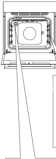
С помощью отвертки подденьте и снимите крышку. Замените лампочку.
