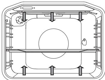
Верхний и нижний нагревательные элементы равномерно излучают тепло внутрь духовки.
