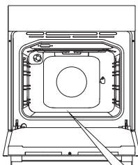
**1** Поверните ПЕРЕКЛЮЧАТЕЛЬ РЕЖИМА НАГРЕВА в положение AquaClean. ПЕРЕКЛЮЧАТЕЛЕМ ТЕМПЕРАТУРЫ установите температуру 70°С.
