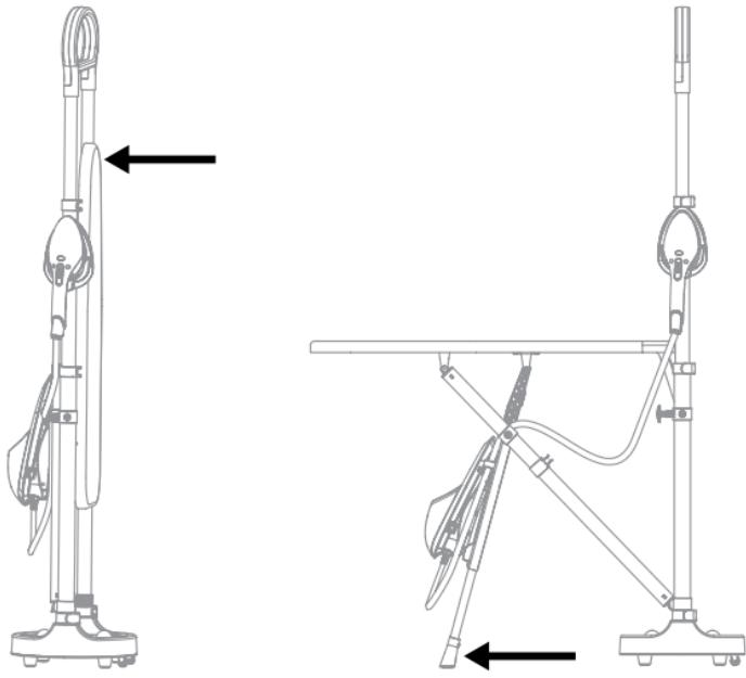
2. При складывании слегка поднимите доску, сложите ножку, затем согните доску вертикальным усилием.
