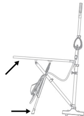
3. Наклоните гладильную систему до 15°, чтобы переместить прибор с помощью колес
