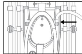
7 Щетку и защитный чехол для утюжка закрепите при необходимости на утюже, чтобы избежать каких-либо травм, убедитесь, что прибор выключен, а утюжок остыл. Протолкните щетку или защитный чехол в надлежащее положение, для фиксации
