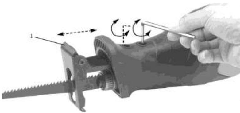
Для регулировки упора **1** (рис. 5) необходимо перевернуть пилу. С нижней стороны имеются 2 отверстия с винтами. Окрутите 2 винта с помощью шестигранного ключа. Минимальное расстояние 10 мм.
