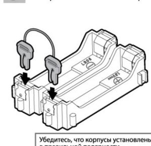
**10** Вставьте стопоры, соединённые с проводами, в корпус для батареек.
