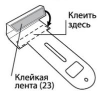
**2** Согните деталь и закрепите место соединения клейкой лентой.
