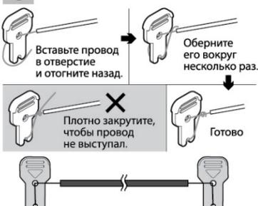
**9** Соедините корпуса для батареек и вставьте стопоры.
