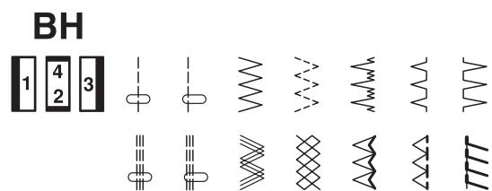
Поднимите иглу и прижимную лапку. Совместите символ нужной строчки с установочной отметкой на панели, повернув регулятор выбора строчек.
