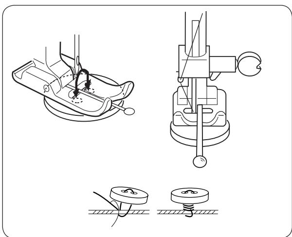
Установите штопальную пластину. Сопоставьте отверстия в пуговице с горизонтальной прорезью на лапке.
