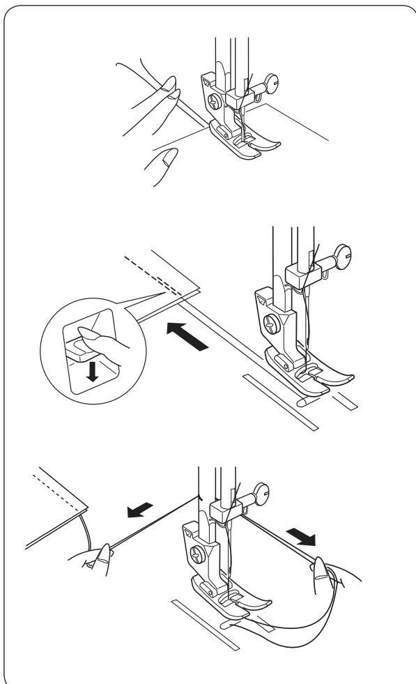
1 Поднимите прижимную лапку и расположите ткань в соответствии с направительными линиями на игольной пластине.
