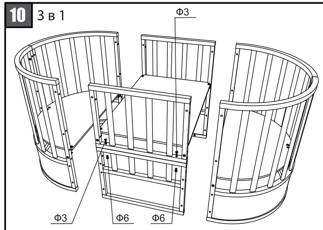
1. Соедините угловые решетки С3 при помощи втулки-гайки Ф6 и винта Ф3.
