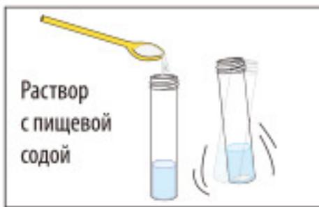
② Налейте 5 миллилитров воды в другую пробирку. Добавьте 1 мерную ложку соды, затем хорошо взболтайте пробирку, чтобы сода растворилась.
