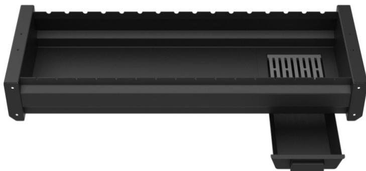
**Жаровня 1000 Pro** - жаровня с зоной подготовки углей, оборудованной чугунным колосником, поддувалом и зольным ящиком. Длина 1000 мм. Щелевые отверстия в колоснике обеспечивают доступ воздуха к углем, что облегчает их розжиг. Длина жаровни позволяет одновременно готовить шашлыки и готовить уголь в зоне подготовки.
