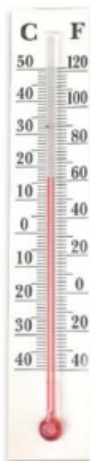
Вместо спирта могут использоваться и другие вещества, но мы провели самый безопасный опыт – с обычной подкрашенной водой. Теперь ты можешь измерять температуру с помощью своего собственного термометра!
