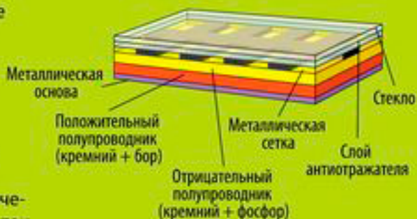
Устройство солнечной панели:
