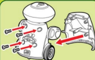
10. Наденьте на основной корпус переднюю панель. Прикрепите её четырьмя длинными винтами.
