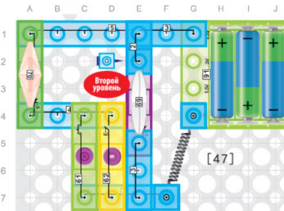
**47. Управление одним светодиодом двумя параллельно соединёнными переключателями**
