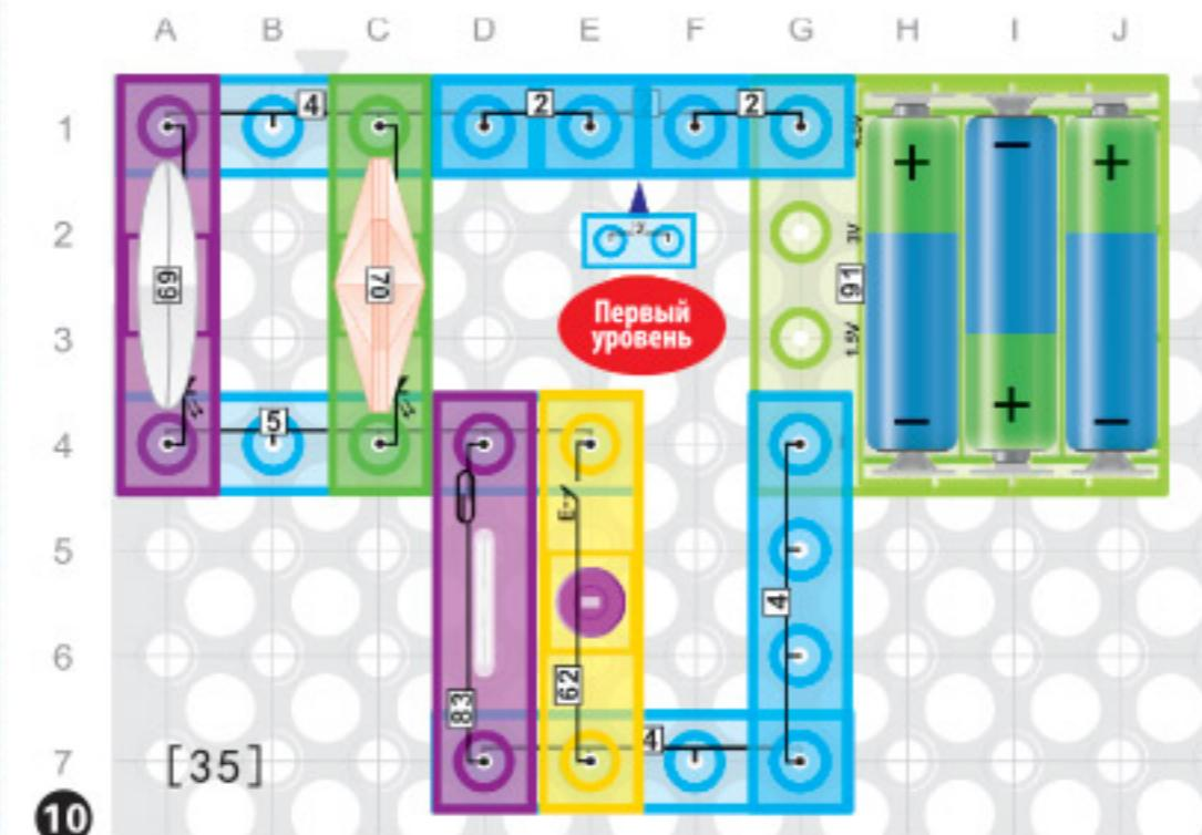
**34. Лампочка, синий светодиод и двунаправленный светодиод в последовательно-параллельном соединении**
