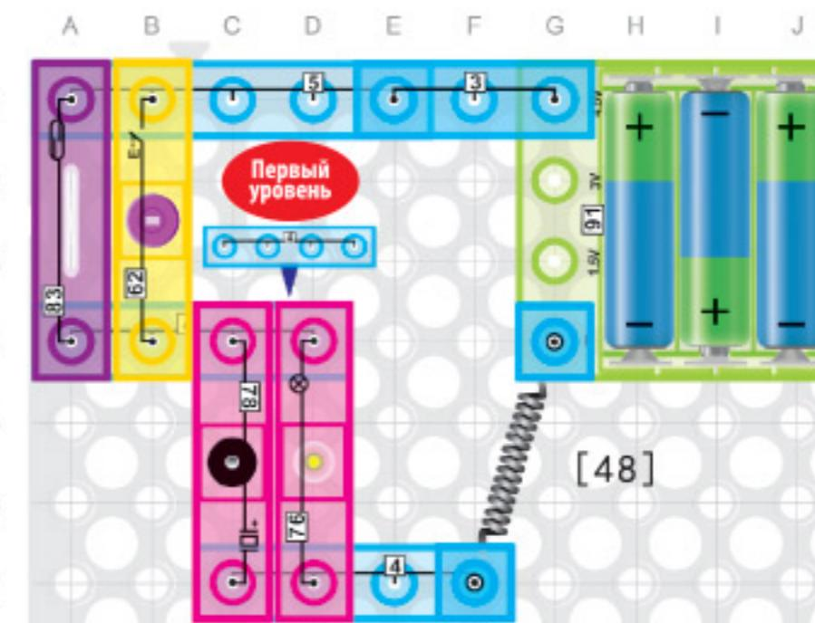
**48. Управление лампочкой и сиреной двумя параллельно соединёнными переключателями**
