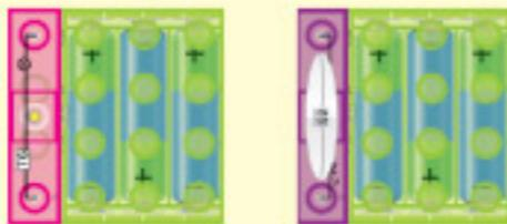
**2. Блоки-проводы 3, пружинный провод 9.** Используйте мини-схему, чтобы протестировать каждый блок с тремя контактами, по одному за каждый раз. Лампочка должна загораться. Замените один 3-контактный блок на пружинный провод – лампочка также должна загореться.
