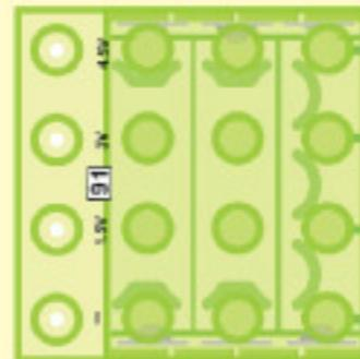
В комплект входит большая прозрачная пластиковая сетка (база) для построения цепей. На ней равномерно распределены отверстия, на которые легко и удобно устанавливаются блоки.
