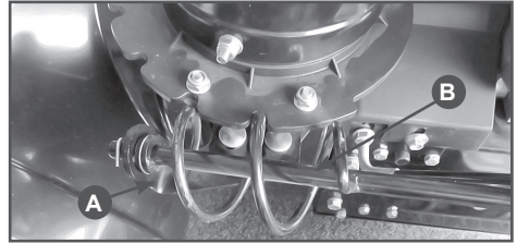
Рис.4 Установка рычага поворота желоба (нижняя часть)
