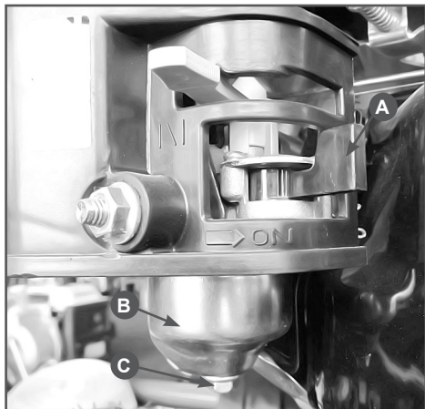
Рис.18 Удаление топлива из бака
