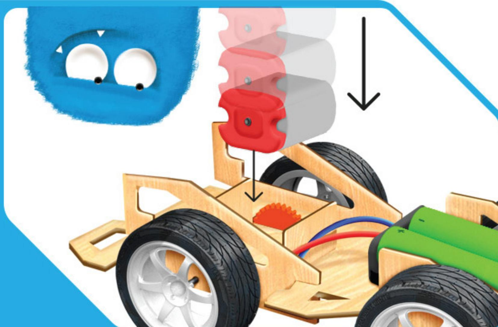
Закройте «моторный отсек» прямоугольной фанеркой с двумя прорезями и закрепите отсек для батареек в передней части машины на клейкую ленту.
