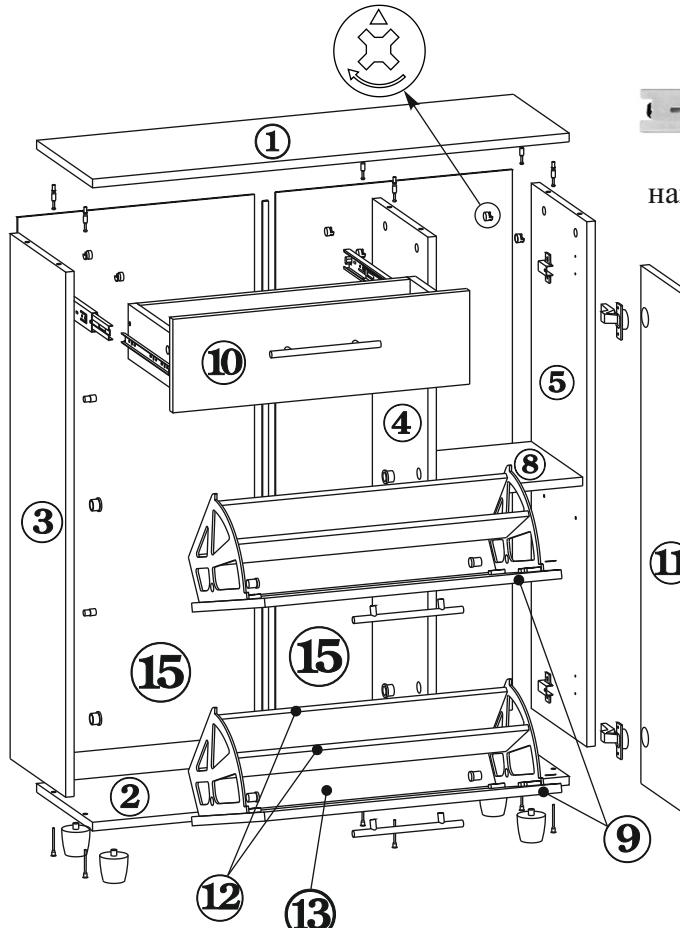
1. В отверстия на боковинах (дет.№3,4) вставьте втулки кронштейнов и ограничители. Шурупами 3,5x16 закрепите шариковые направляющие. Шурупами 3x20 закрепите магнитные защелки. В отверстия на боковинах (дет.№3,4,5) вставьте эксцентрики.
