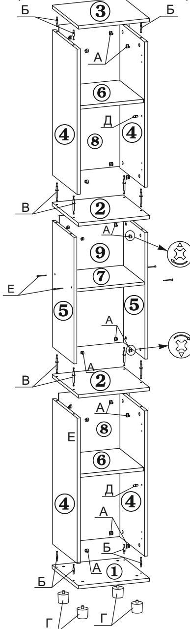
1. Вставьте эксцентрики в отверстия на боковинах (дет.№№4,5) вставьте эксцентрики (поз.А). **Обратите внимание: стрелка на эксцентрике должна быть направлена к торцу детали.**
