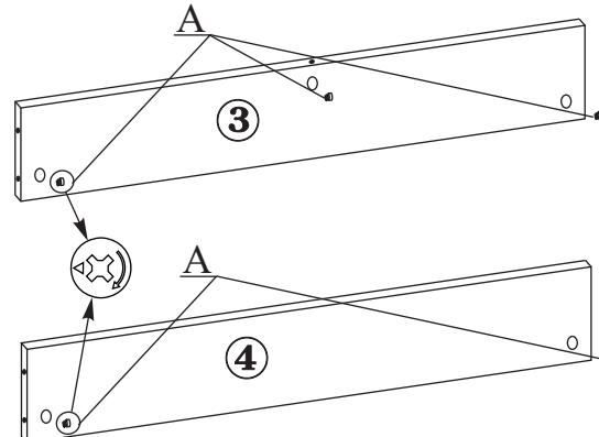
1.2. В отверстия царг (дет№3,№4) установите эксцентрики (поз.А) так чтобы стрелка была направлена в сторону торцевого отверстия.
