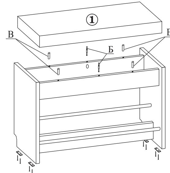
1.5 Снизу на торцах боковин, гвоздями закрепите наконечники (поз.Д).
