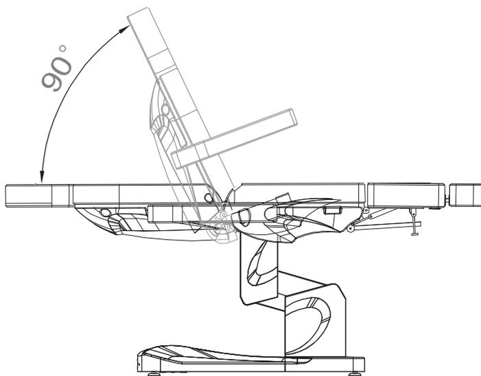
6.4. Для регулировки кресла по углу наклона потяните вверх стопорный рычаг, расположенный за спинкой кресла. При этом кресло за счет пневматического цилиндра начнет наклоняться вперед. Отпустите рычаг, когда кресло примет нужное положение.
