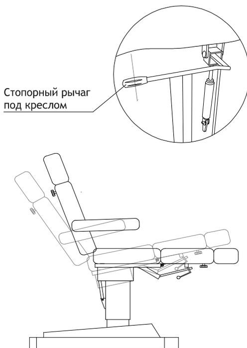
6.5. Регулировка подголовника осуществляется только по высоте. Для регулировки открутите стопорный винт сзади подголовника.
