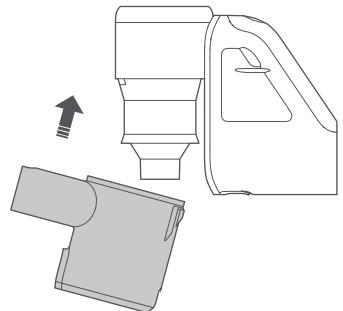
5. Слегка надавливайте на отсек для пыли в направлении, показанном на рисунке, пока не услышите щелчок, означающий, что отсек для пыли зафиксирован.
