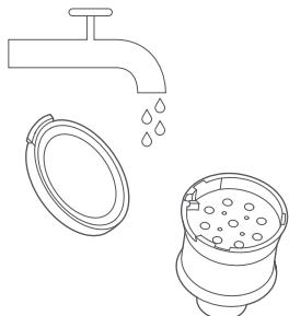
5. Чтобы просушить фильтр и циклонный блок, после чистки оставьте их в прохладном и хорошо проветриваемом помещении по крайней мере на 24 часа.
