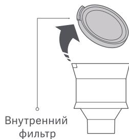
4. Промывайте фильтр и циклонный блок о тех пор, пока они не станут чистыми. Выжмите фильтр после того, как промоете.
