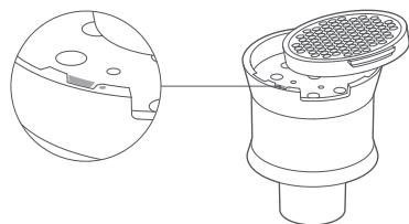
3. Совместите циклонный блок с пылесосом, как показано на рисунке, и вставьте его на место, повернув по часовой стрелке.
