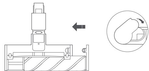
6. Поверните защелку на 90° по часовой стрелке, чтобы зафиксировать валик.
