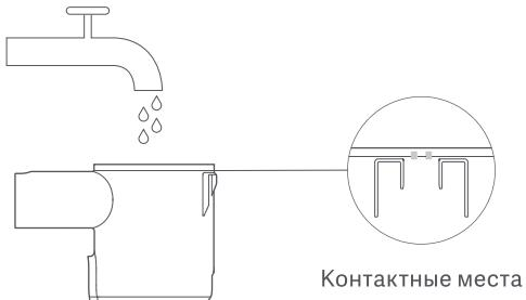
5. После полного высыхания отсека для пыли следуйте инструкциям на приведенном ниже рисунке, чтобы установить его обратно.
