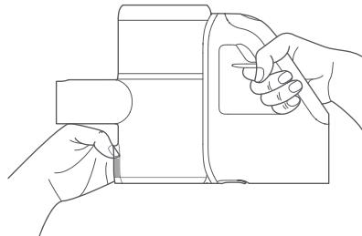
3. Нажмите на расположенную рядом с отсеком для пыли кнопку в направлении стрелки, отделите отсек от пылесоса и промойте его водой.
