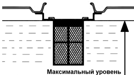
Рис. 7 Максимальный уровень топлива
