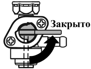
Рис. 12 Топливный кран закрыт
