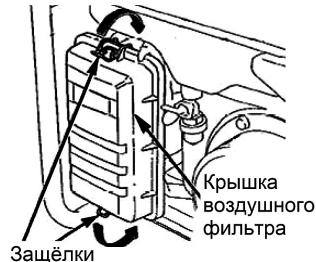
Рис. 21 Снятие крышки воздушного фильтра
