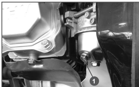
Рис. 26 Слив топлива из карбюратора 1. Болт сливного
