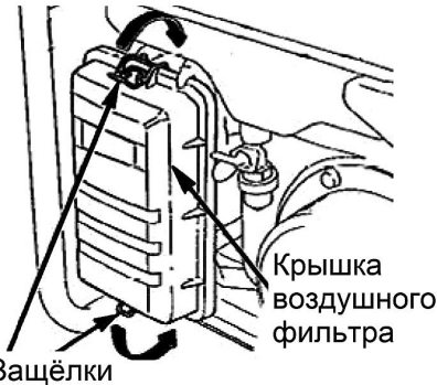
Рис. 14 Снятие крышки воздушного фильтра
