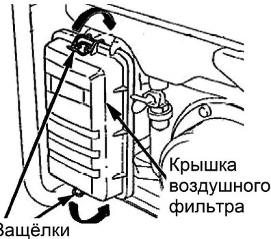
Рис. 14 Снятие крышки воздушного фильтра
