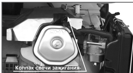
Рис. 14 Место расположения свечи зажигания
