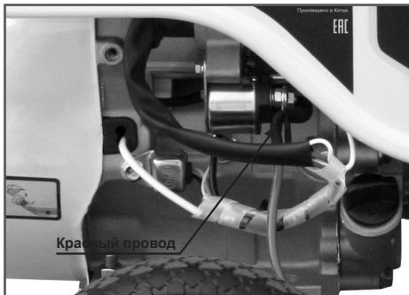
Рис. 7 Подключение плюсовой клеммы аккумулятора
