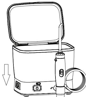
3) Вставьте насадку в отверстие держателя насадок до щелчка. Чтобы извлечь насадку нажмите на кнопку снятия насадки и потяните насадку вверх.
