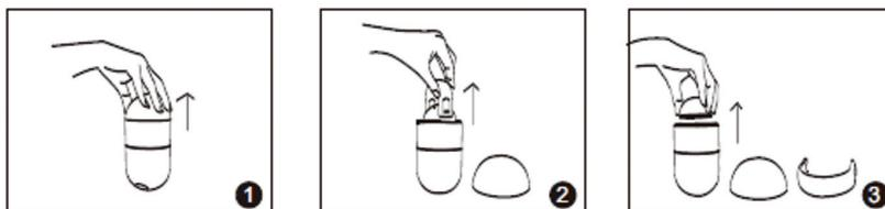
Поверните выдвижную часть отпаривателя так, чтобы указатель на выдвижной части оказался над значком открытого замка, и потяните выдвижную часть в противоположную сторону от нижней части отпаривателя. Затем поверните выдвижную часть так, чтобы указатель на выдвижной части оказался над значком закрытого замка.
