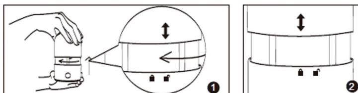
Вставьте ручку в отверстия для фиксации ручки, при этом нажмите на кнопки фиксаторов на ручке.
