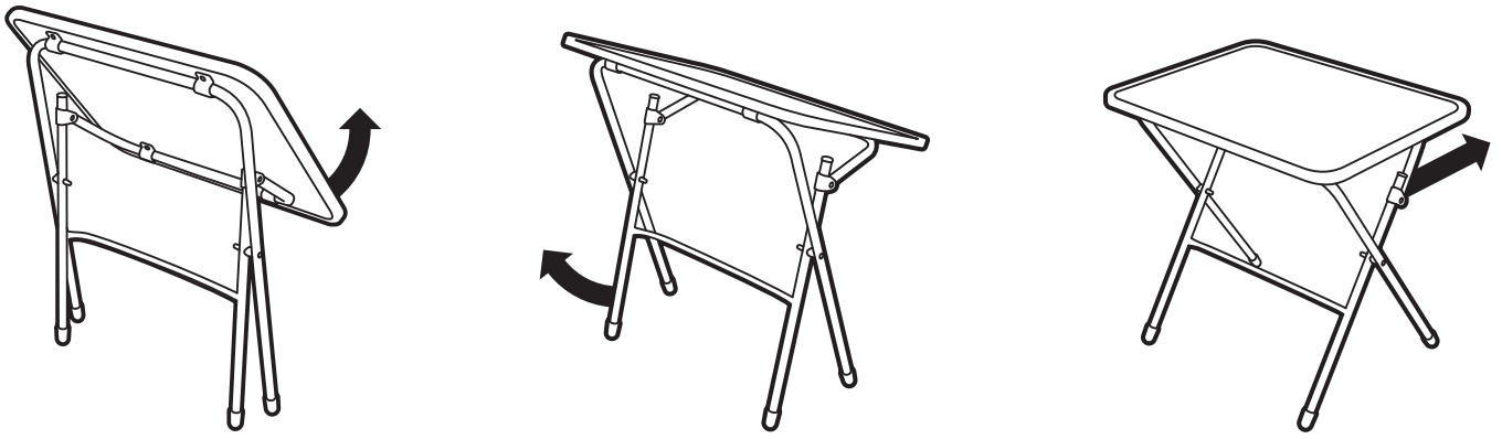
(рис. 3) Схема раскладывания стола (механизм «Никки»)
