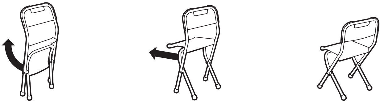
(рис. 5) Схема раскладывания стула с пластмассовым сиденьем
