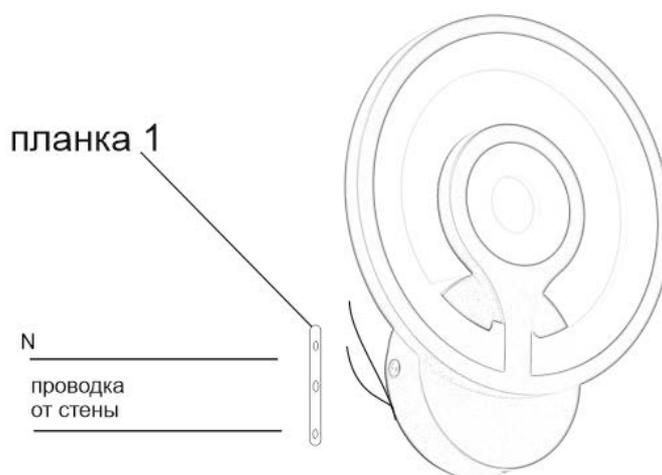
Рис.1 Сборка светильника
