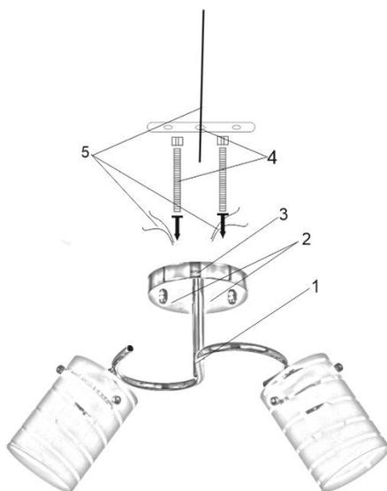
Рис.1 Сборка светильника
