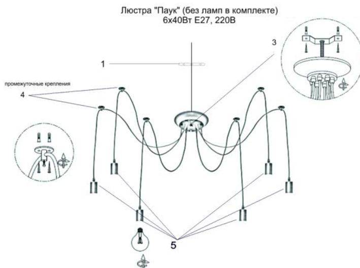
Рис.1 Сборка светильника
