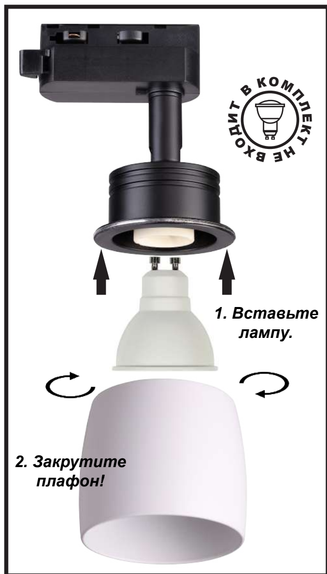
Схема сборки трекового светильника.
