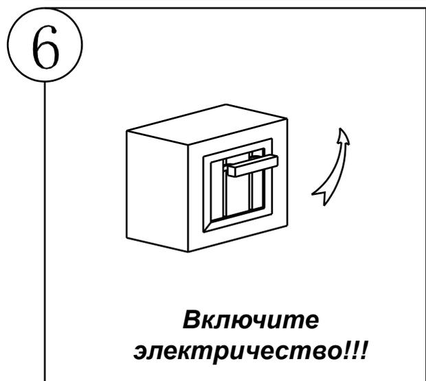
**ВНИМАНИЕ.** Все работы по монтажу шинпровода и установке светильников, замене ламп и техническому обслуживанию следует проводить при отключенном напряжении питания шинпровода. Категорически запрещается производить перемещение светильников вдоль шинпровода во включенном состоянии.
