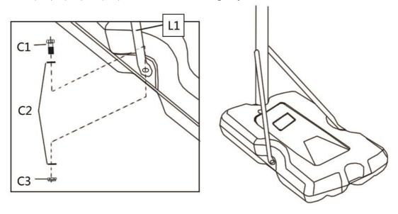
Закрепите другой конец опорных скоб (L1) и (L2) с двух сторон к основанию(S) комплектов болтов (C1),(C2) и (C3) как показано на рисунке.
