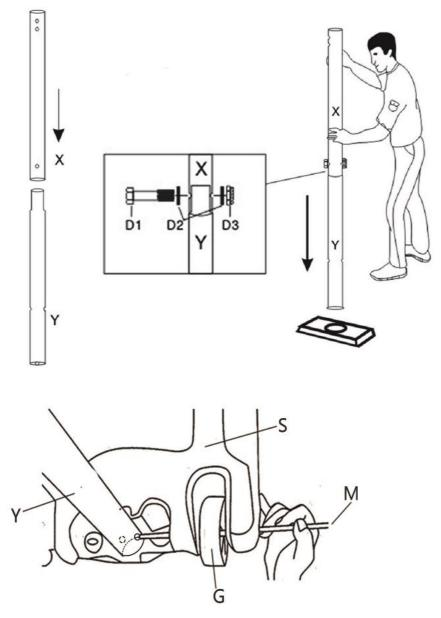
Вставьте втулку колеса (M) в колесо (G), основание (S) и конец нижней стойки (Y) ка показано на рисунке.
