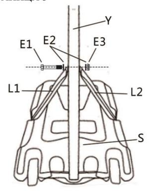
Закрепите один конец опорных скоб (L1) и (L2) к нижней стойке (Y) комплектом болтов (E1), (E2) и (E3) как показано на рисунке.
