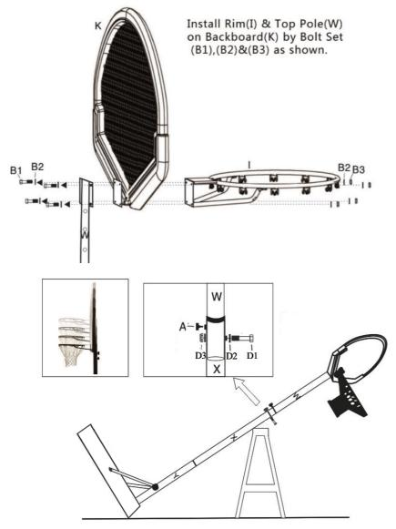
Вставьте верхнюю стойку (W) в среднюю стойку (X), отрегулируйте нужную высоту, затем закрепите ручкой регулирования (A) и набором винтов(D1),(D2)и(D3) как показано на картинке. Регулируйте высоту, вставляя набор винтов (D1),(D2)и(D3) в разные отверстия верхней стойке (W).
