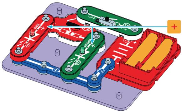
Собери схему со светодиодами 17, 26 и датчиком наклона 72, как показано на рисунке, правильно соблюдая полярность. **Не забудь вставить батарейки!** Включи ползунковый переключатель 15, чтобы механизм заработал. Затем наклони или сдвинь всю конструкцию – красный или зелёный светодиод загорится. Поэкспериментируй со схемой, чтобы увидеть, какой из светодиодов активируется при определённом наклоне. Если цепь лежит на плоской поверхности и не выключается, слегка наклони её.
