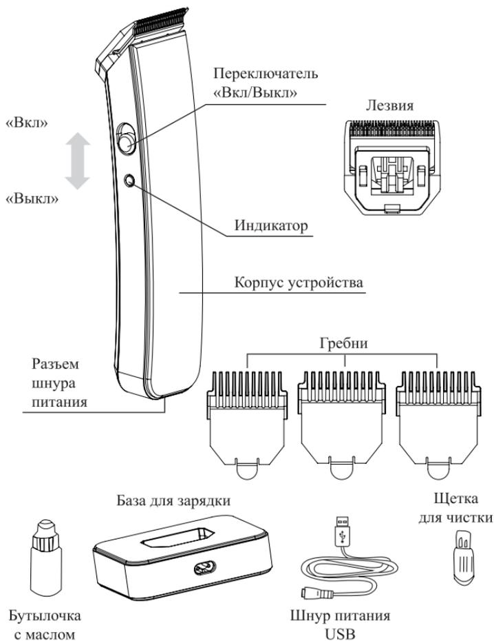
Переключатель «Вкл/Выкл» расположен сбоку устройства. Положение переключателя: сверху — включено, снизу — выключено.
