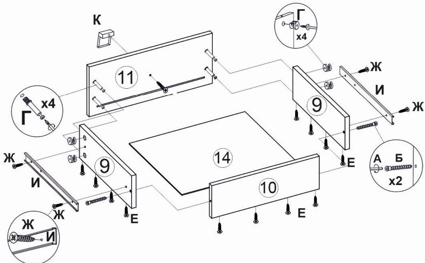
! Для установки шариковых направляющих в изделие, необходимо разъединить их на две части. Широкая часть устанавливается на боковую стенку каркаса, а узкая на боковую стенку выдвижного ящика.
