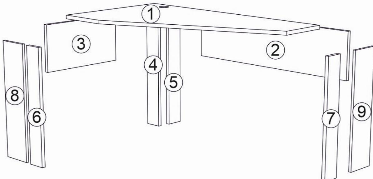
! Допускается как лево-, так и правосторонняя сборка. Будьте внимательны и используйте только те отверстия и кернения, которые задействованы в выбранном Вами варианте сборки.
