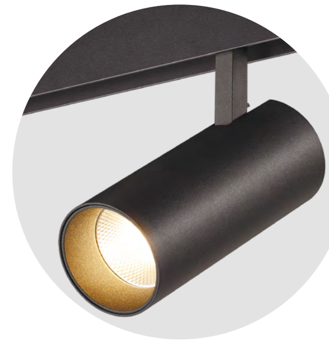
358629 358630 IP 20 Трековый светильник для низковольтного шинпровода диммируемый с пультом управления со сменой цветовой температуры Алюминий 12 Вт 48 В max 1080 Лм 3000-6500 К Цвет LED плавный переход от теплого до холодного Угол поворота по горизонтали 350° по вертикали 90° Угол рассеивания 38°
