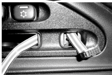
Рис. 2. Порядок укладки шлейфа.
