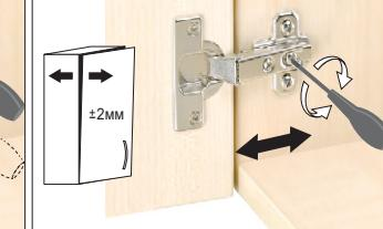
Ослабить крепежный винт и отрегулировать
