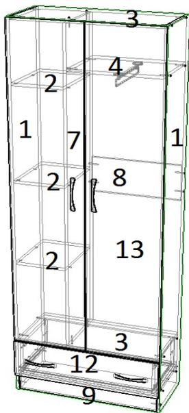
Шурупами привернуть петли к детали 13 и установить фасады на корпус шкафа в готовые наметки.
