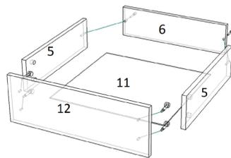
Еврошурупами скрепить детали 6 и 5 в пропил установить ЛДВП. В готовые отверстия в детали 12 вернуть эксцентрики и скрепить с корпусом
