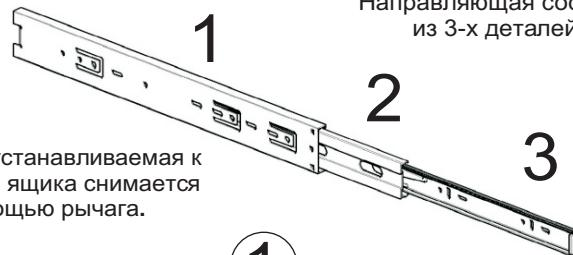
Деталь устанавливаемая к боковине ящика снимается с помощью рычага.
